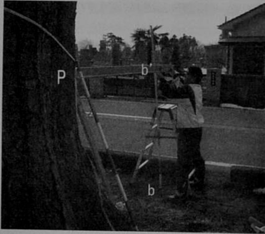
図7 b' - P間距離の測定状況
